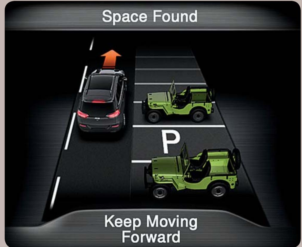
El sistema de ayuda al aparcamiento en paralelo/batería disponible se muestra en el centro del cuadro de instrumentos. Los gráficos muestran al conductor los pasos necesarios para utilizar el sistema de ayuda al aparcamiento.
