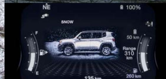
**SNOW** Añade estabilidad y reduce el sobreviraje para lograr mayor seguridad y rendimiento en carreteras cubiertas de nieve o hielo. Los principales sistemas son gestionados automáticamente para garantizar una marcha suave.
