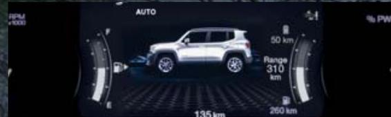
**AUTO** Selección predeterminada que es perfecta para la conducción cotidiana y utiliza el motor eléctrico trasero cuando es necesario accionar el sistema 4x4 eléctrico.
