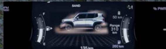
**MUD / SAND** Utiliza el sistema 4x4 eléctrico para aumentar el par y la tracción a bajas velocidades, implementa los controles de chasis específicos, los diferenciales y las relaciones de transmisión para dominar la arena y el barro.
